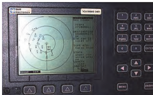
Slika 1.3. AIS: Prikaz azimuta i udaljenosti od drugih brodova u radarskom formatu (izvor: web)
