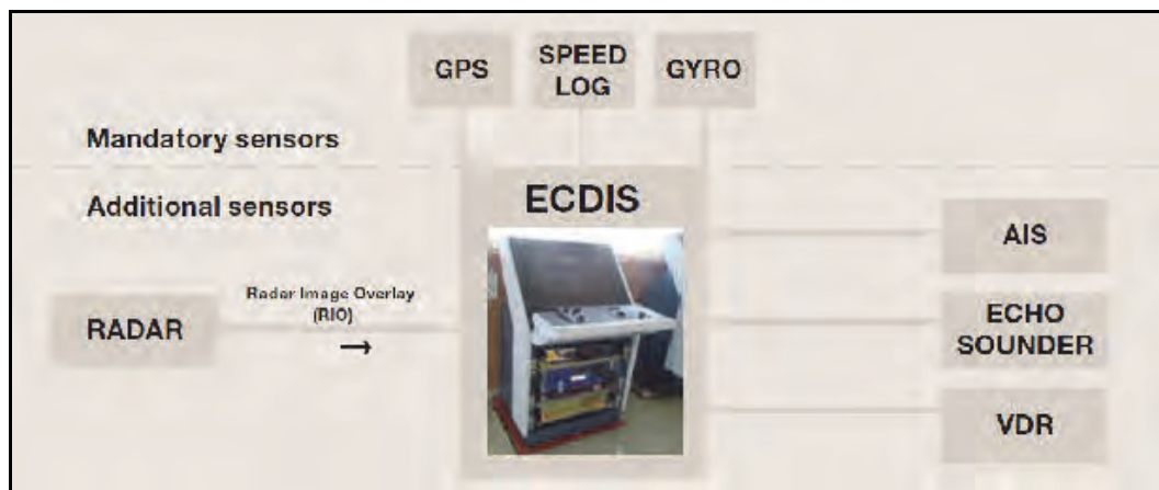
Slika 2.3. Uređaji na brodu sa kojih ECDIS integriše podatke/informacije (izvor: [20])
