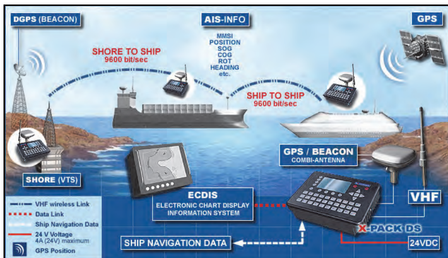
Slika 1.1. Koncept funkcionisanja AIS (X-Pack DS) uređaja (izvor: [5])
