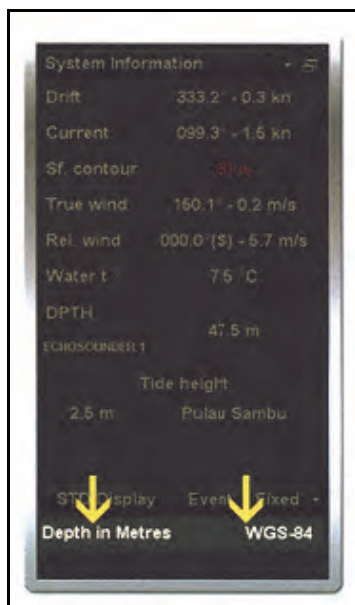
Slika 2.6. Oznaka referentnog geodetskog sistema na Transas -ovom ECDIS displeju (izvor: [3, p.10])
